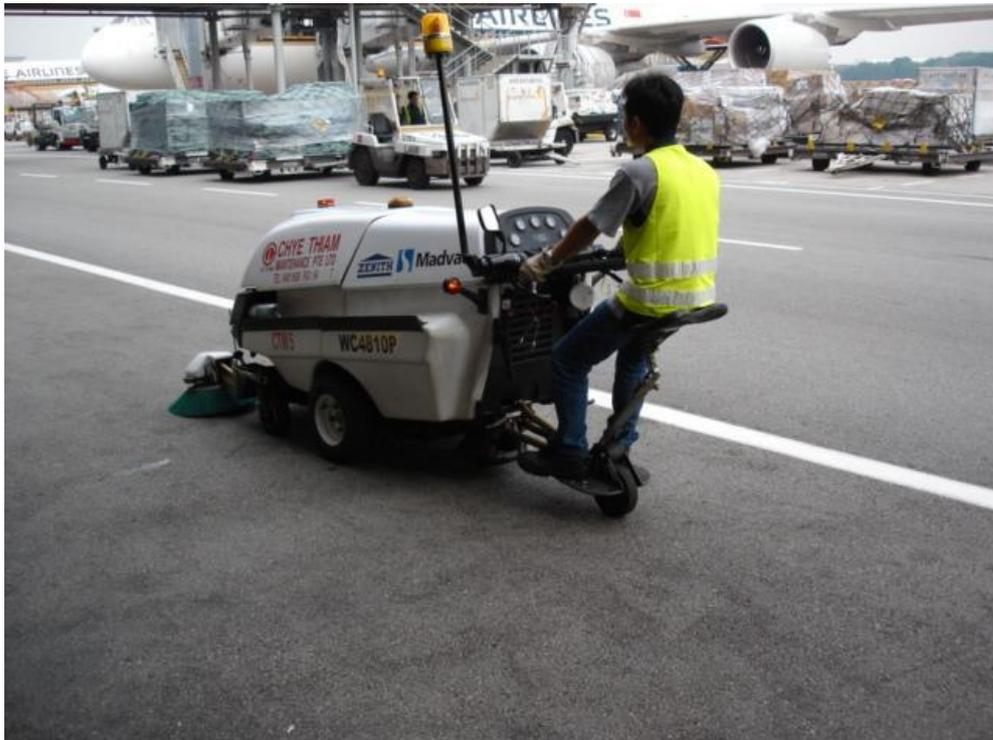
大型清掃車可用來清掃大量之 FOD，且附吸鐵可清除金屬類 FOD
